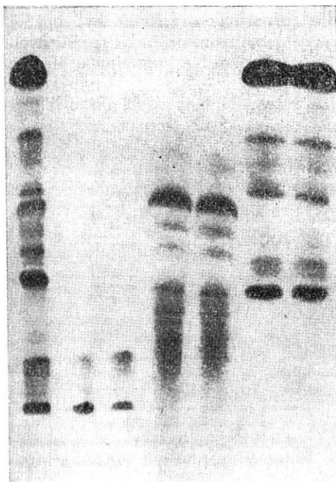
4. Fotosnímek elektroforetické distribuce bílkovin krevního séra ve škrobovém gelu (první ferogram zleva), I. vrcholové frakce (2. a 3. ferogram), II. vrcholové frakce (4. a 5. ferogram) a III. vrcholové frakce (6. a 7. ferogram) z gelové filtrace na Sephadexu G - 200
